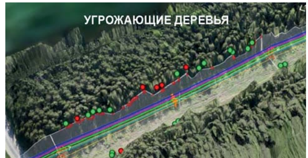
Рис. 5. Погрешность обследования ВЛ на наличие ДКР с помощью БАС составляет 1–2%, что позволяет более точно составлять техническое задание и смету на вырубку (очистку) леса и, как следствие, снижать среднюю стоимость расчистки 1 км трассы ВЛ 110 кВ на 20–30%
