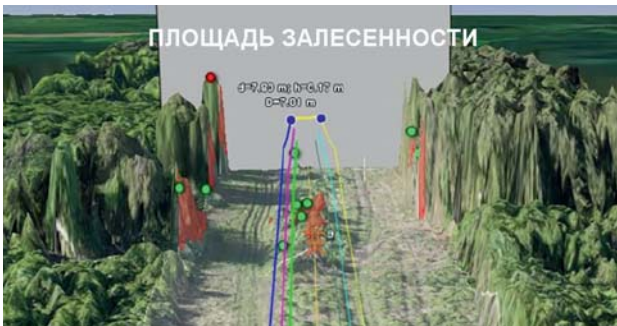
Рис. 5. Погрешность обследования ВЛ на наличие ДКР с помощью БАС составляет 1–2%, что позволяет более точно составлять техническое задание и смету на вырубку (очистку) леса и, как следствие, снижать среднюю стоимость расчистки 1 км трассы ВЛ 110 кВ на 20–30%
